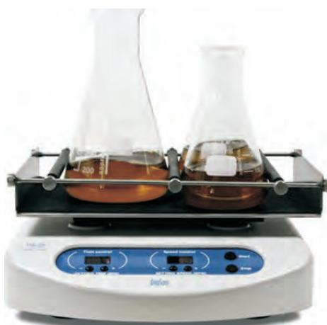
Микропроцессор шайкера обеспечивает контроль времени и оборотов.
