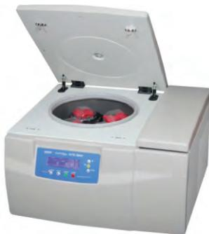
Вентилируемые центрифуги MPW-380 и центрифуги с охлаждением MPW-380R представляют линейку высокопроизводительных, универсальных настольных лабораторных центрифуг. Это первые импортные настольные центрифуги, в которых реализована возможность выбора русского языка в меню. Центрифуги MPW-380 и MPW-380R используются в медицинских, промышленных, биохимических, ветеринарных и других лабораториях. Они обеспечивают высокую производительность и точность процесса центрифугирования.
