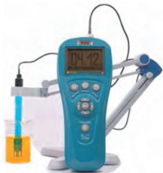
Иономер И-510 предназначен для определения в водных растворах активности ионов водорода ( $\text{pH}$ ), окислительно-восстановительного потенциала ( $\text{Eh}$ ), концентрации (активности) ионов:
