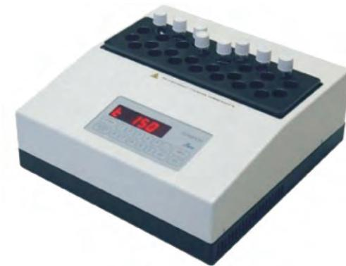
Термопрессор лабораторный «ТЕРМИОН» предназначен для нагревания проб в реакционных сосудах до заданной температуры и выдержке при ней заданное время.
