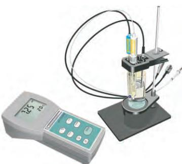
РН-метр рН-150МИ предназначен для измерения активности ионов водорода (рН), окислительно-восстановительного потенциала и температуры водных растворов.
