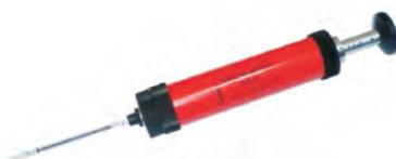
Аспиратор "Насос-пробоотборник НП-ЗМ" (далее – НП-ЗМ) предназначен для отбора разовых проб газовоздушных смесей с целью последующего определения их химического состава с использованием индикаторных трубок
