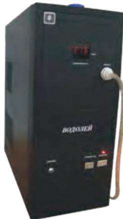
Прибор предназначен для получения в лабораторных условиях особо чистой воды, используемой для приготовления растворов, хроматографических проб, заправки электролитических генераторов водорода/кислорода и других целей.
