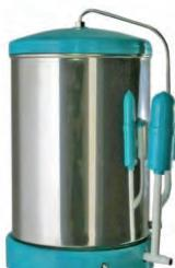
**Назначение:** Для производства дистиллированной воды из исходной путем её нагрева до кипения с дальнейшей конденсацией водяного пара и получением дистиллята с температурой около 80°C.
