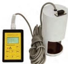
Предназначен для контроля недостаточного или избыточного содержания кислорода, а также опасной загазованности горючими и токсичными газами в воздухе рабочей зоны.
