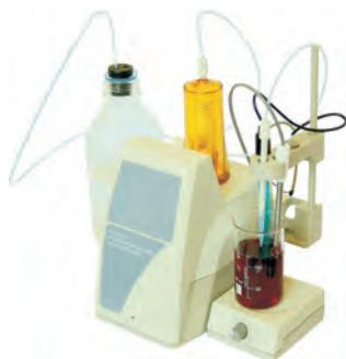
АТП-02 – автоматический высокоточный потенциометрический титратор. Прибор отвечает всем требованиям, предъявляемым к данному классу оборудования: непрерывная и дискретная подача титранта (диапазон от 0,1 до 36 мл/мин – при объёме дозирующего устройства 20мл; и от 0,25 до 90 мл/мин – при объёме дозирующего устройства 50мл), автоматическое изменение скорости подачи по мере приближения к точке эквивалентности или заданной точке и т.д.
