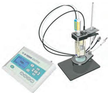
Предназначен для прямого и косвенного потенциометрического измерения активности ионов водорода ( $\text{pH}$ ), активности и концентрации других одновалентных и двухвалентных анионов и катионов ( $\text{px}$ ), окислительно-восстановительных потенциалов ( $\text{Eh}$ ) и температуры в водных растворах с представлением результатов в цифровой форме и в виде аналогового сигнала напряжения постоянного тока.
