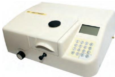
Концентрационный фотоэлектрический фотометр КФК-3-01 (ЗОМЗ) - является фотометром № 1 в России и СНГ.
