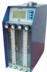
Предназначен для автоматического отбора проб воздуха, паров и аэрозолей (в рабочей зоне, атмосфере и промышленных выбросах) для проведения санитарного и экологического контроля. Аспиратор обеспечивает отбор проб с заданным объемным расходом через поглотитель по 4-м параллельным каналам. (1,2 канал 0,2-2 л/мин, 3,4 каналы 2-20 л/мин - серийное исполнение см. \*) Отобранные пробы анализируются в лабораторных условиях с применением стандартных методик.
