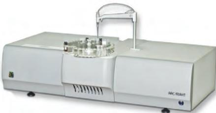
Электротермическая атомизация пробы в быстро нагреваемой графитовой трубчатой кювете, с коррекцией спектральных помех основанной на использовании обратного эффекта Зеемана. Предназначен для количественного определения элементов в жидких пробах различного происхождения и состава на уровне долей нг/л (ppt.)
