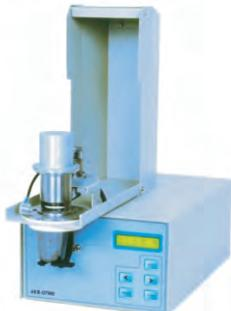
Анализатор вольтамперометрический АКВ-07МК с твердотельным электродом - современный микропроцессорный прибор, предназначенный для качественного и количественного анализа различных объектов на содержание ионов тяжелых металлов и токсичных элементов:
