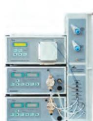
Ионный хроматограф "Стайер-А". Специализированный ионный хроматограф «Стайер-А» используется для анализа следовых количеств различных неорганических и органических ионов (включая анионы карбоновых кислот) в особо чистых водных средах, в том числе в технологических водах предприятий тепловой и атомной энергетики и микроэлектронной промышленности.
