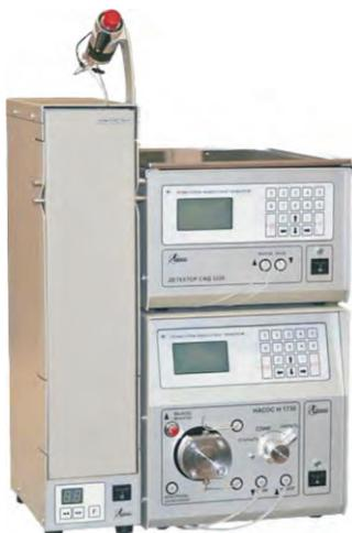
Жидкостный хроматограф «ЛЮМАХРОМ®» со спектрофотометрическим /флуориметрическим / спектрофлуориметрическим детектированием предназначен для качественного и количественного определения органических веществ в сложных пробах методом высокоеффективной жидкостной хроматографии. Блочно-модульный принцип позволяет создать оптимальную конфигурацию прибора в зависимости от решаемых задач аналитической лаборатории – от рутинных до исследовательских.
