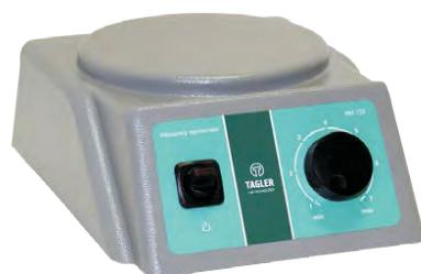
Очень качественная российская магнитная мешалка. Позволяет перемешивать жидкости объемом до 10 литров со скоростью до 3 000 об/мин.
