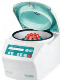
Модель EBA 200 - это практичная малая центрифуга для небольших объемов проб. В стандартной комплектации оснащена 8-местным угловым ротором для размещения пробирок объемом до 15 мл. EBA 200 достигает максимального относительного центробежного ускорения (RCF) 3 461 и является идеальным вариантом для решения довольно широкого спектра задач, наиболее востребована в методе Плазмолифтинг (Plasmolifting).
