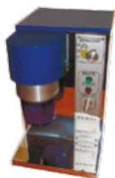
Предназначена для механизированного замеса теста при определении количества и качества клейковины в цельномолотом зерне и муке по ГОСТ 13586.1-68, ГОСТ 27839-88. Имеет встроенный узел подачи воды. Тестомесилка применяется на хлебоприёмных, мукомольных и хлебопекарных предприятиях.
