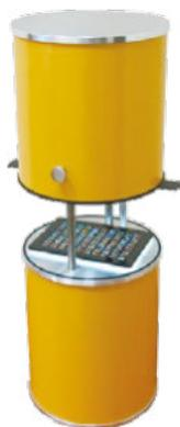
Предназначен для определения стекловидности зерна пшеницы путём просвечивания исследуемого зерна направленным световым потоком.
