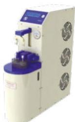
Прибор ПЧП-7 отличается от других приборов ПЧП встроенной системой охлаждения, позволяющей не подключать его к источнику воды и не использовать слив. Данные изменения позволяют экономить воду в объёмах до 1000 литров в день и делают прибор автономным в условиях сельскохозяйственных лабораторий.
