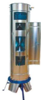
Аппарат предназначен для перемешивания образца зерна и выделения из него средних и среднесуточных проб, деления средней пробы пополам и выделения навесок массой 25, 50 и 100 г.
