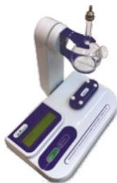
Соматос-В (весовой) — линейка анализаторов соматических клеток в молоке, пришедшая на смену «Соматос-М». По принципу действия приборы соответствуют методике, изложенной в ГОСТ 23453-90. Отличительным преимуществом является то, что вместо инфракрасного сенсора для определения времени вытекания в анализаторах используются высокоточные электронные весы.
