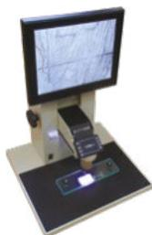
Трихинеллоскоп последнего поколения с расширенными возможностями и электронным выводом изображения на жидкокристаллический дисплей, предназначен для диагностики трихинеллеза в продуктах убоя домашних и диких животных, а также для других видов оволяргельмикроскопии.
