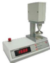
Предназначен для определения качества клейковины зерна пшеницы и пшеничной муки. Соответствует ГОСТ 13586.1-68, ГОСТ 27839-88. Процесс измерения полностью автоматизирован. Прибор обладает системой внутренней диагностики, что позволяет исключить подстройку и юстировку в течение всего периода эксплуатации.
