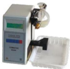
Вискозиметрический анализатор молока «СОМАТОС Мини» предназначен для контроля качества молока и определения количества соматических клеток в молоке по условной вязкости, измеряемой по времени вытекания контролируемой пробы через капилляр. Метод определения количества соматических клеток в молоке, применяемый в данном анализаторе, полностью соответствует ГОСТ 23453-90.
