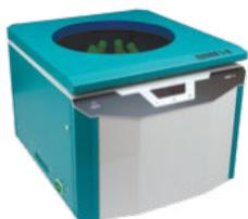
Молочная центрифуга TAGLER ЦЛМН 1-8 - является центрифугой для молока нового поколения. Сохранила свойства популярных в России молочных центрифуг, она приобрела новые, очень ценные дополнения. Оснащена таймером для контроля времени работы и автоматического отключения. Автоблокировка препятствует включению электродвигателя при открытой крышке.
