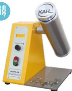
Лабораторная мельница ВЬЮГА-3М предназначена для измельчения проб масличных культур (подсолнечник, рапс и др.) с влажностью не выше 20% и содержанием жира не более 55%. Мельница пригодна для измельчения проб зерновых, зернобобовых культур, кормов и сырья для их производства. Используются при подготовке проб для определения влажности, содержания белка, жира, клетчатки, а также для анализа методом инфракрасной спектроскопии.
