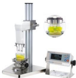
Вибровискозиметры SV-10, SV-100 — прорыв в вискозиметрии. Уникальный метод камертонной вибрации, разработанный японской компанией AnD, позволяет выполнять измерения в широком диапазоне без замены сенсорных пластин.
