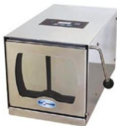
Предназначен для гомогенизации проб и получения жидкой фракции образцов для микробиологического анализа. Прибор позволяет избежать применения вибрационных и скоростных смесителей, повреждающих клетки в образце.
