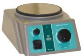
Компактная магнитная мешалка TAGLER MM-135H, изготовленна из ударопрочного пластика с рабочей поверхностью из нержавеющей стали. Прибор обеспечивает перемешивание жидкости со скоростью вращения элемента до 2600 об/мин (зависит от размеров перемешивающего элемента, объёма и вязкости жидкости, формы сосуда).
