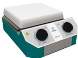
MM-180H представляет собой компактную магнитную мешалку с рабочей поверхностью, изготовленной из алюминиевого сплава со специальным керамическим покрытием. Прибор обеспечивает перемешивание жидкости со скоростью вращения магнитного элемента до 1500 об/мин.
