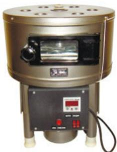
Сушильный шкаф используется для высушивания образцов в процессе подготовки проб к анализу.
