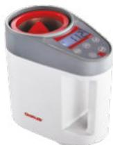
Ручной анализатор влажности зерна MC2000 предназначен для точного определения содержания влаги в зерне, в том числе для контроля его качества при хранении. Простые настройки и удобный интерфейс повышают производительность труда, позволяя быстро получать достоверные результаты. Программы: рис индика, соя, рис японика, рис, пшеница, ячмень, кукуруза, арахис, рапс, дурра, кофе, лён, подсолнечник.
