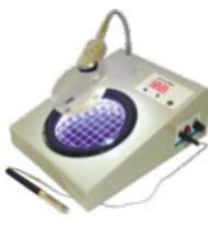
Предназначен для подсчёта колоний микроорганизмов в чашках Петри путём нажатия пером в районе нахождения колоний. Прибор регистрирует факт касания. Результат выводится на цифровое табло.
