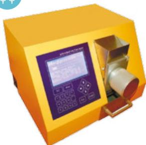
Экспресс-анализатор для определения целого ряда показателей качества зерновых, зернобобовых, масличных культур, комбикормов (таких как влажность, белок, количество клейковины, жир, клетчатка, зольность и др.) путем измерения оптических характеристик специально подготовленных проб анализируемых продуктов в ближней инфракрасной области спектра.
