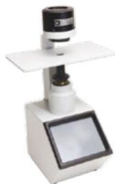
Трихинеллоскоп «Стейк» предназначен для контроля заражения трихинеллезом продуктов убоя домашних и диких животных в условиях лабораторий. Также трихинеллоскоп применяется для контроля рыбы на рыбоприёмных пунктах и рыбоперерабатывающих предприятиях для диагностики паразитарных заболеваний. Метод контроля компрессорный.
