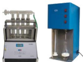
Анализ по методу Кьельдаля является самым распространённым и точным способом определения белка в различных продуктах. Он имеет ряд недостатков — это низкая скорость, громоздкое оборудование, использование агрессивных реагентов. Уменьшить недостатки метода позволяет применение полуавтоматического комплекса, который состоит из блока озоления (дигестора), скруббера, водоструйного насоса, блока дистилляции и титровальной установки.
