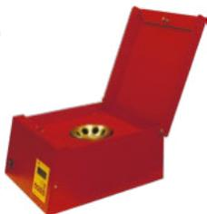
Центрифуга Nova Safety — надёжная настольная молочная центрифуга с нагревом для определения содержания жира в молоке по ГОСТ Р ИСО 2446-2011. Управление центрифугой осуществляется с помощью панели с дисплеем. Крышка центрифуги автоматически блокируется при старте и до полной остановки ротора.
