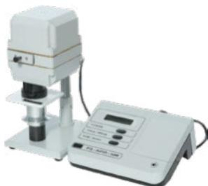
Белизомер РЗ-БПЛ-ЦМ предназначен для определения качества и сортности муки. Особенностью белизомера является возможность использования сменных модулей с различными светофильтрами для измерения показателя белизны не только муки, но и сахара, мела, крахмала, бумаги и др. Метод определения белизны устанавливается ГОСТ 26361-84, который распространяется на сортовую хлебопекарную пшеничную и ржаную муку.
