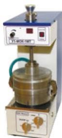
Устройство У1-МОК-1МТ предназначено для отмывания и отжима сырой клейковины из зерна (шрота) и муки пшеницы без применения ручного труда. Отмывает клейковину из проб зерна пшеницы всех типов и муки всех сортов любого качества. Простота и надёжность конструкции, удобство в работе и обслуживании обеспечивают комфортность выполнения трудоёмкой операции по отмыванию клейковины и ускоряют процесс в 2-2,5 раза.
