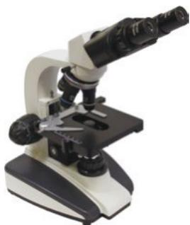
Микроскоп биологический Биолаб 5 может быть использован в повседневной рутинной работе в различных лабораториях. Микроскоп имеет светлопольный конденсор Аббе для работы по методу светлого поля и может быть дополнительно укомплектован конденсором темного поля.
