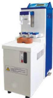
Прибор для определения числа падения ПЧП-5 предназначен для контроля качества зерна, муки и других крахмалосодержащих продуктов. Прибор реализует метод определения числа падения по ГОСТ 27676 и международным стандартам ICC 107, ISO 3093-82. Принцип метода основан на быстрой клейстеризации водной суспензии пробы продукта в кипящей водяной бане и последующем измерении степени разжижения клейстера под действием альфа-амилазы, содержащейся в пробе.
