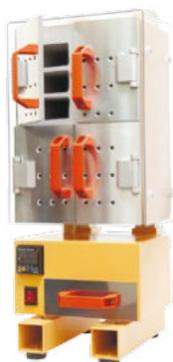
Предназначен для определения влажности в твёрдых, сыпучих и пастообразных материалах согласно стандартизированным методикам.
