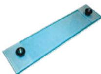
Компрессорий МИС-7 на 28 проб предназначен для расплющивания проб мяса при исследовании на наличие трихинелл и финн. Исследуемые пробы размещаются в пронумерованные прямоугольники. Верхняя пластина плотно прижимается с помощью винтов для расплющивания исследуемого мяса.
