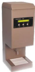
Предназначен для выделения личинок трихинелл методом переваривания в искусственном желудочном соке. Только методом переваривания возможен групповой анализ проб шпика, сала, замороженного и брекетируемого мяса.
