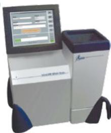
Прибор предназначен для проведения количественного экспресс-анализа цельного зерна различных культур без предварительной пробоподготовки, а также идентификации зерна на принадлежность его к характерной группе продукции. За одно измерение, в течение полутора минут, можно определить содержание белка, жира, крахмала, клетчатки, клейковины, влажность, стекловидность и др.
