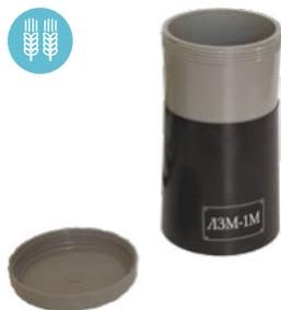
Мельница ЛЗМ-1М предназначена для измельчения проб зерновых, зернобобовых культур и других твёрдых пищевых продуктов (например, макарон) с влажностью не выше 18,0% для определения их качества.
