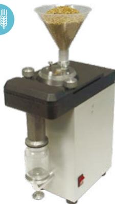
Лабораторная мельница циклонного типа для размола зерновых культур влажностью до 20%. Подходит также для размола комбикормов с низким содержанием жира, сои. Мельница может быть использована для пробоподготовки при анализе образцов на инфракрасном анализаторе, при определении количества и качества клейковины.
