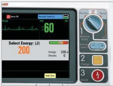
Ручная дефибрилляция: режим асинхронизированной дефибрилляции для электроимпульсной терапии при фибрилляции желудочков. Режим синхронизированной дефибрилляции для электроимпульсной терапии при фибрилляции предсердий. Широкий выбор уровней энергии до 360 Дж значительно повышает эффективность помощи различным пациентам. Индикатор контакта упложенного / присасывающегося электрода предоставляет пользователю информацию о сопротивлении перед каждым разрядным импульсом.
