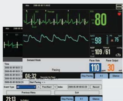
BeneHeart D6 позволяет осуществлять кардиостимуляцию в режиме по команде или в фиксированном режиме с настраиваемой частотой и уровнем энергии. Клавиша 4:1 позволяет врачу быстро выбрать 1/4 заданной частоты кардиостимулатора для наблюдения за базовой частотой сердечных сокращений пациента.
