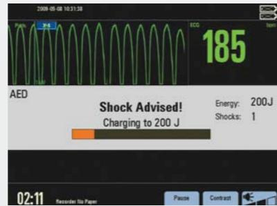
В режиме АНД BeneHeart D6 автоматически анализирует частоту сердечных сокращений и определяет целесообразность подачи электрического импульса. Голосовые и текстовые подсказки помогают пользователю в эксплуатации оборудования. Для анализа работы персонала имеется функция записи речи (180 минут).
