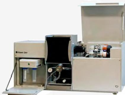
Спектрометр предназначен для количественного определения примесей металлов в жидких пробах различного происхождения и состава по атомным спектрам поглощения и эмиссии. С автоматически юстируемой шестиламповой турелью и автоматическим монохроматором. Определяет до 70 химических элементов. Пределы обнаружения от 0,05 мкг/л.
